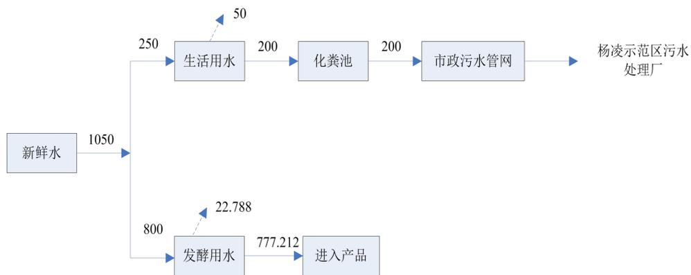
图 2-1 项目水平衡图 单位： $\text{m}^3/\text{a}$
