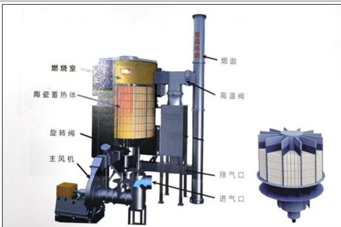
图 4：焚烧炉工艺原理
