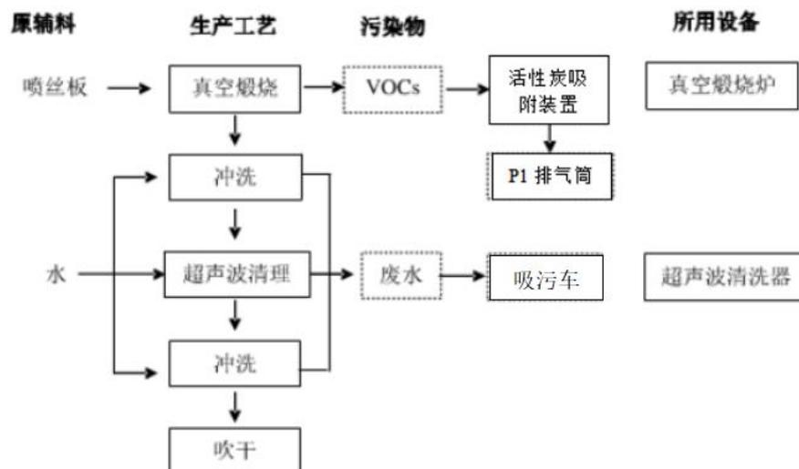
图 5-2 喷丝板清洗工艺流程图
